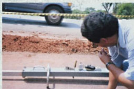
Foto 7 – Medidas das deflexões recuperáveis com a Viga Benkelman
