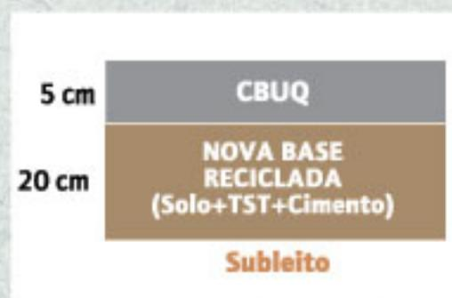
de brita graduada (BGS) sobre o tratamento superficial triplo existente (TST) e uma capa de rolamento de 5 cm de concreto betuminoso usinado a quente CBUQ (Figura 2).
