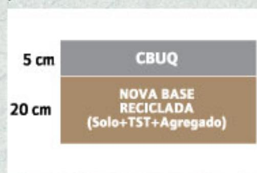
Misturas com a adição de material pétreo ao produto fresado foram preparadas e analisadas, obtendo-se resultados satisfatórios para a percentagem de 20% de agregados, que apresentaram em média limite de plasticidade menor do que 26% e NP. Confeccionados com o uso da energia do próctor modificado, os corpos de provas apresentaram, após seus rompimentos, capacidades de suporte (CBR) com valores superiores a 80%.
