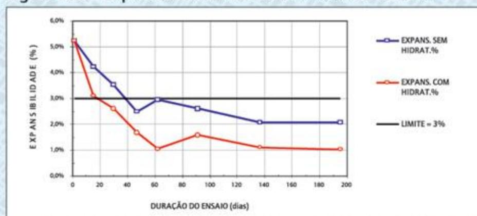
Figura 1.3 – Expansibilidade obtida com escória da Fonte C
