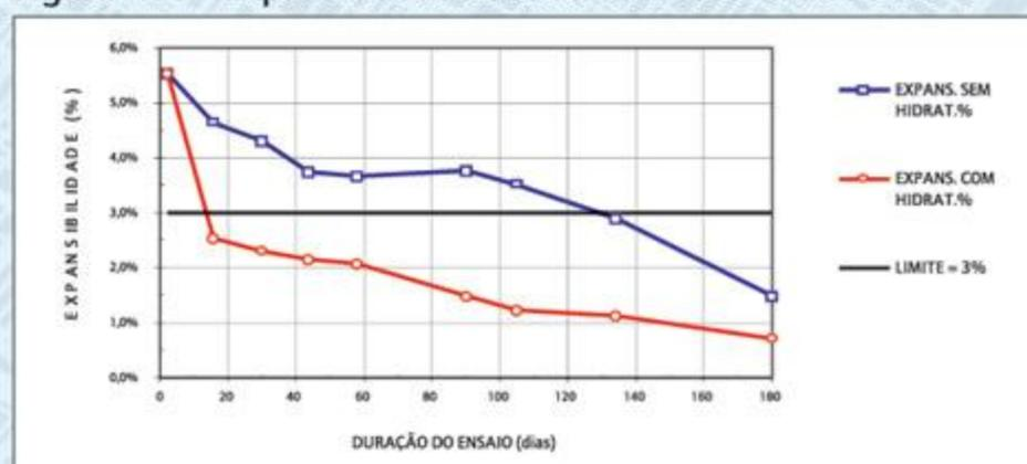
Figura 1.5 - Gráfico da expansibilidade média obtida com escórias das fontes A, B, C e D, mantidas sem tratamento de hidratação diária e com tratamento de hidratação diária.
