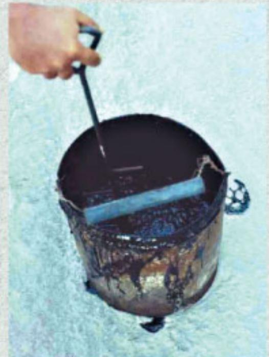
*Detalhe da medição da expansão e meia vida da espuma de asfalto*
