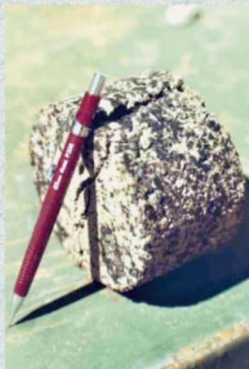
Detalhe do corpo de prova após rompimento
