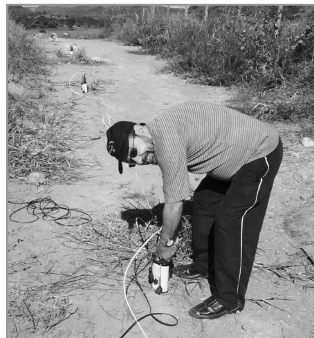
Na foto, equipamento é instalado no local e José Flávio verifica um dos módulos que compõe o sismógrafo
